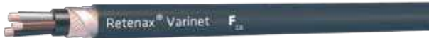
Los cables tipo RETENAX VARINET están diseñados para interconexión de variadores de frecuencia con motores. Su pantalla es también el conductor de protección.
